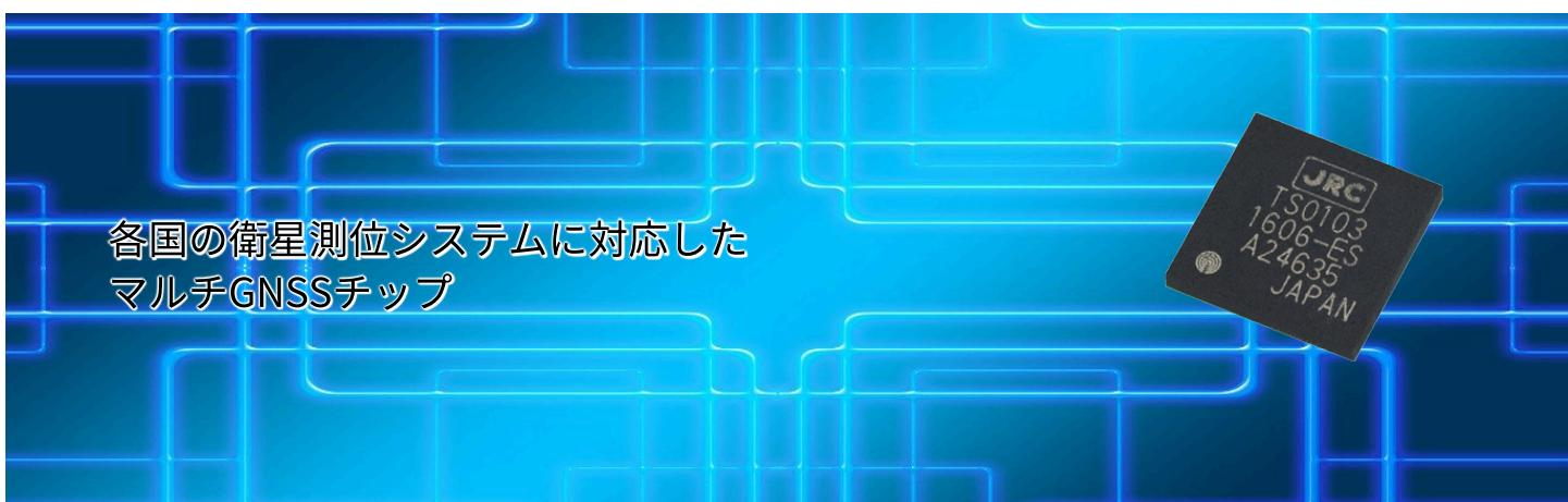
マルチGNSSチップ 7DLTS0103は、GPS（米国）、準天頂衛星システム（日本）、GLONASS（ロシア）、BeiDou（中国）の衛星に対応したチップタイプのマルチGNSSモジュールです。
