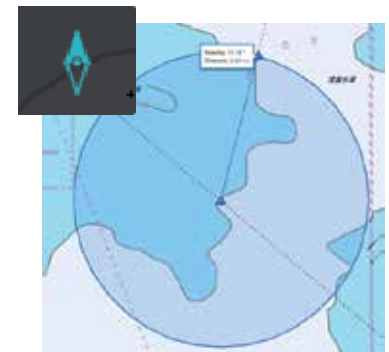
EBL・VRM 測定 レーダー画面をイメージした方位と距離を測定表示
