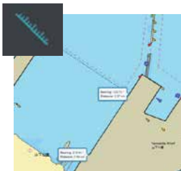
方位・距離測定 地図上で 2 点間の方位と距離を測定表示
