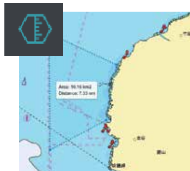
面積・外周距離測定 地図上で指定した範囲の面積と外周距離を測定表示
