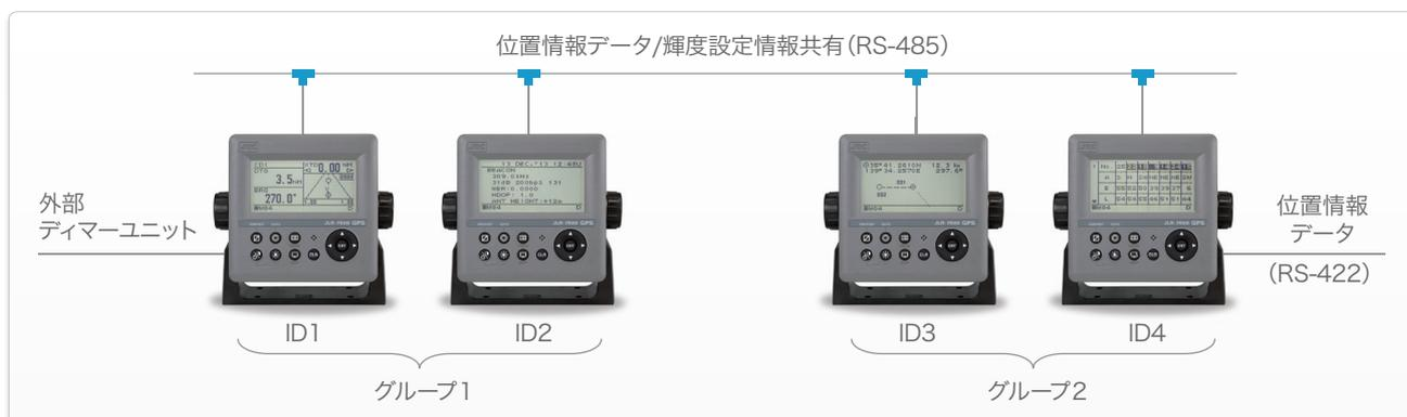
上記の接続例ではID4の表示器ではGPS受信機より位置情報データを受信 (RS-422) し、接続されている全ての表示器に送信 (RS-485) する。画面輝度情報の共有は外部ディマーユニットで制御されるグループ1と表示機のキーで制御するグループ2の独立した2つのグループに分割されている。
