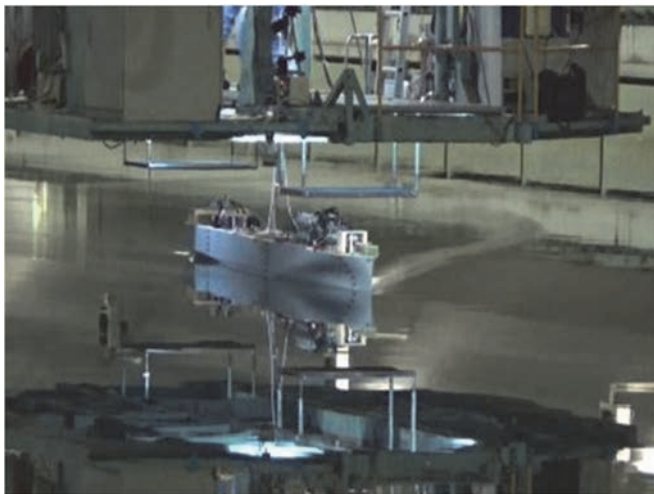
図5 離着岸操船システム 模型実験
