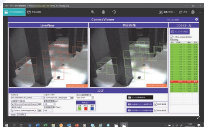
図7 FO漏れ検知システム
