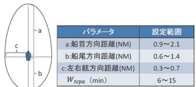
図6 バンパーモデルと調整パラメータ
